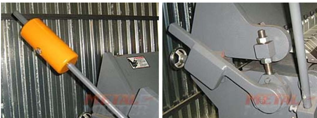
В процессе работы с листом требуется также регулировка усилия прижима детали и установка положения прижимной балки. Это проводится без специальных приспособлений. Прижимная балка перемещается путем поворота вентиля, расположенного с другой стороны листогиба.
